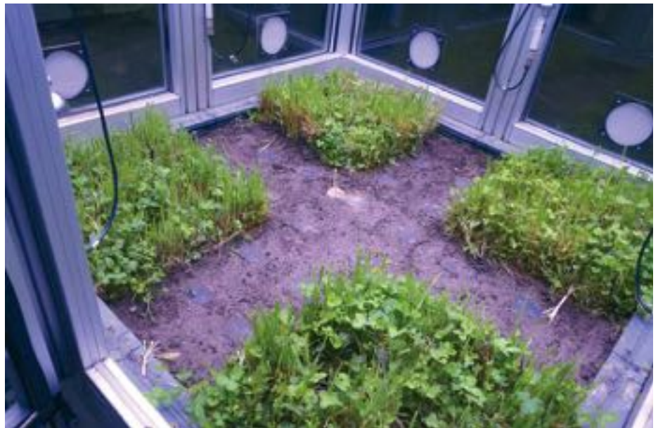
In derartigen Versuchsanordnungen wurden die Lichtverhältnisse in der Nacht simuliert und gezielt verändert. Foto: Myriam Hirt
